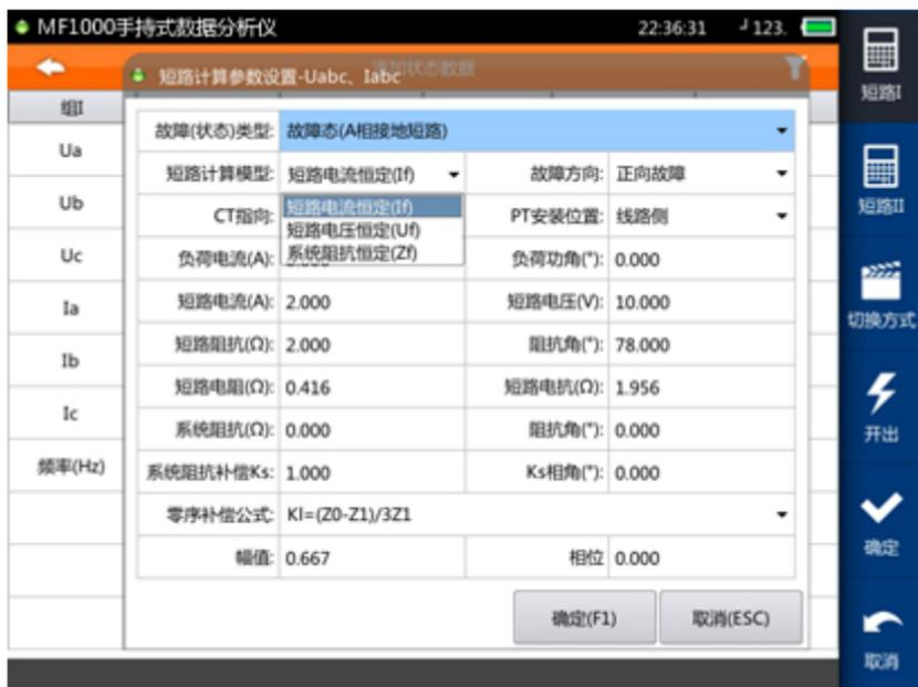
按照设定的短路参数进行短路计算，控制采样值输出量；
