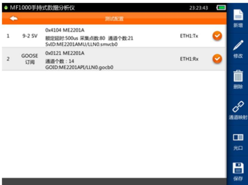
测试配置主要用来定义电流电压、状态序列、Goose 发布等保护功能测试模块需要用到的 SV/GS 控制块。
